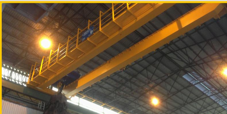
Carroponte automatico con polipo movimentazione batterie al piombo.
