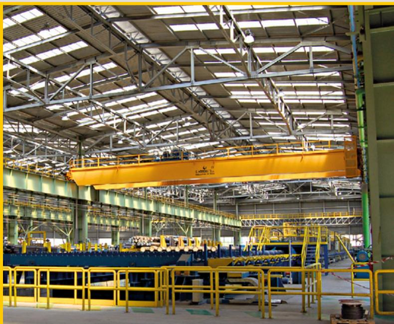
Carroponte per acciaieria movimentazione barre in acciaio reparto trattamenti termici.
