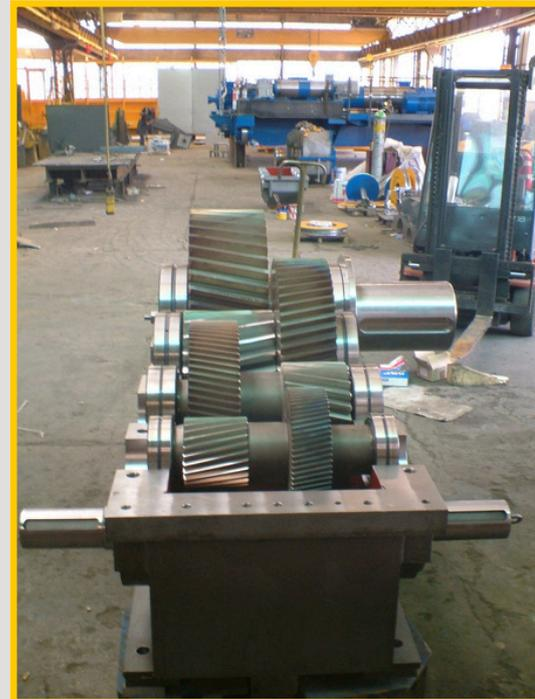
Particolare riduttore ad assi paralleli progettato su misura per l'applicazione specifica.
