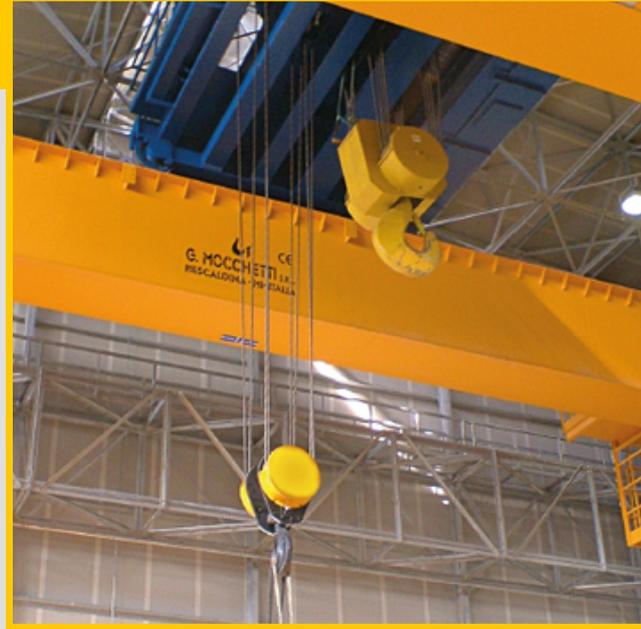
Particolare carrello per carro ponte magazzino barre.
