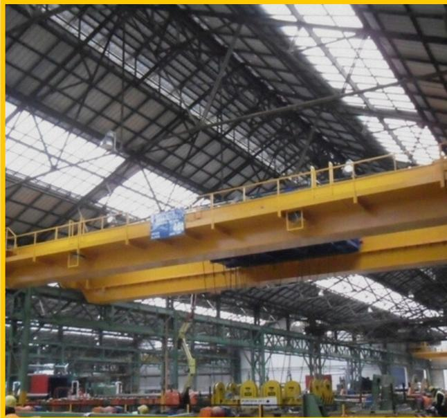
Carroponte automatico per stoccaggio tubi ad alta pressione.
