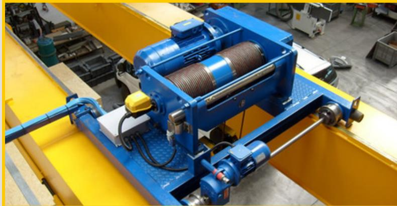
Carrello principale per operazioni di carico/scarico siviera, progettato con struttura rialzata per consentire il passaggio del carrello ausiliario al di sotto.
