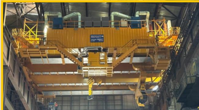
Carroponte per movimentazione coils con cabina traslante indipendente.
